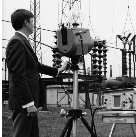
Abbildung 14.2 1969: Modell 661 der Thermovision. Die Kamera wog ca. 25 kg, das Oszilloskop 20 kg und das Stativ 15 kg. Für den Betrieb wurden darüber hinaus ein 220-Volt-Generator und ein 10-Liter-Gefäß mit flüssigem Stickstoff benötigt. Links neben dem Oszilloskop ist der Polaroid-Aufsatz (6 kg) zu erkennen.
