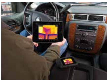
Bilder über WLAN in FLIR Tools laden
