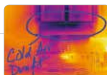
Zeichnen auf dem IR-/ Digitalbild – Gespeicherte Bilder auf dem Touchscreen mit Kreisen, Pfeilen usw. aufbereiten
