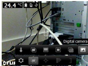
Per visualizzare un'immagine fusione di buona qualità (modalità *MSX*, *Picture-in-picture* e *Dissolvenza termica*) la termocamera deve effettuare delle regolazioni per compensare la lieve differenza di posizione tra l'obiettivo della videocamera digitale e l'obiettivo ad infrarossi. Per regolare l'immagine in maniera precisa, la termocamera richiede una distanza di allineamento (cioè la distanza dall'oggetto).
