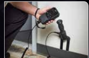
Vor Ort austauschbarer Temperatur-/rel. Luftfeuchtesensor
