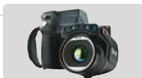
Caméra numérique intégrée de 5 mégapixels, LED, pointeur laser, bouton de capture d'image et focalisation automatique/manuelle. Bloc optique tournant sur 120°
