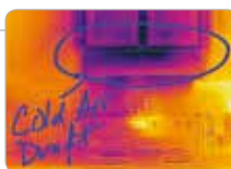
Tracé sur image IR/Visible - Utilisez l'écran tactile pour dessiner des cercles, des marques... sur les images enregistrées
