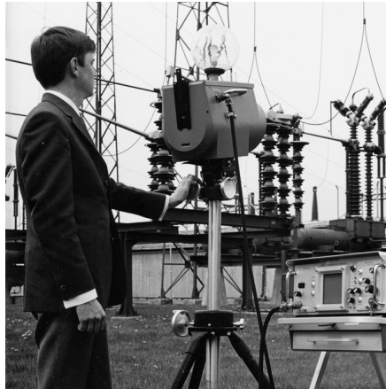
Abbildung 31.2 1969: Modell 661 der Thermovision. Die Kamera wog ca. 25 kg, das Oszilloskop 20 kg und das Stativ 15 kg. Für den Betrieb wurden darüber hinaus ein 220-Volt-Generator und ein 10-Liter-Gefäß mit flüssigem Stickstoff benötigt. Links neben dem Oszilloskop ist der Polaroid-Aufsatz (6 kg) zu erkennen.
