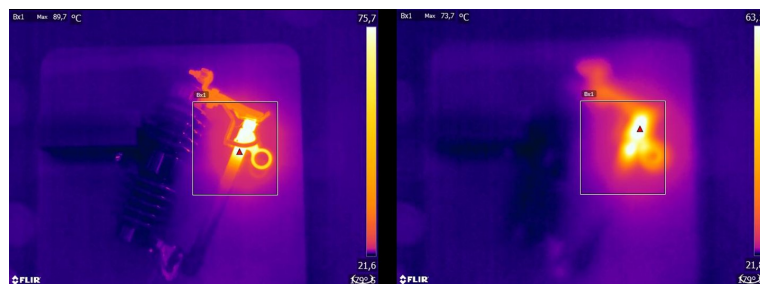
Abbildung 34.2 Gut fokussiertes Wärmebild (links) mit einer maximalen Temperatur T_{\max} = 89,7 \text{ °C} und schlecht fokussiertes Wärmebild (rechts) mit einer maximalen Temperatur T_{\max} = 73,7 \text{ °C} .
