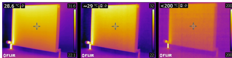
Abbildung 34.4 Bilder von einer FLIR T440 mit Temperaturbereichen von -20 bis +120 °C, (links), 0 bis +650 °C (Mitte) und +250 bis +1200 °C (rechts). Alle anderen Einstellungen sind unverändert.
