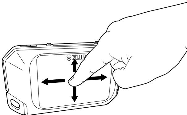
La termocamera è dotata di touchscreen. È possibile utilizzare il dito indice o una penna stilo creata appositamente per l'utilizzo del touch capacitivo per navigare nel sistema di menu.
