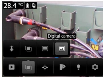
Per visualizzare un'immagine di fusione di buona qualità (modalità *MSX*), la termocamera deve effettuare delle regolazioni per compensare la lieve differenza di posizione tra l'obiettivo della videocamera digitale e l'obiettivo ad infrarossi. Per regolare l'immagine in maniera precisa, la termocamera richiede una distanza di allineamento (cioè la distanza dall'oggetto).
