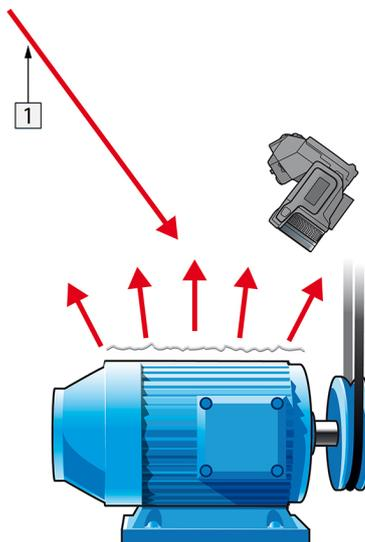
Figura 15.5 Misurazione della temperatura apparente del foglio d'alluminio.
