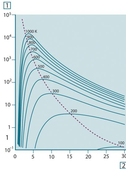
**Figura 18.6** Curve di Planck rappresentate graficamente su scale semilogaritmiche da 100 °K a 1000 °K. La linea tratteggiata rappresenta il punto di massima emittanza spettrale per ogni valore di temperatura, come descritto dalla legge di Wien. 1: Emittanza energetica spettrale ( $\text{W}/\text{cm}^2 (\mu\text{m})$ ); 2: Lunghezza d'onda ( $\mu\text{m}$ ).
