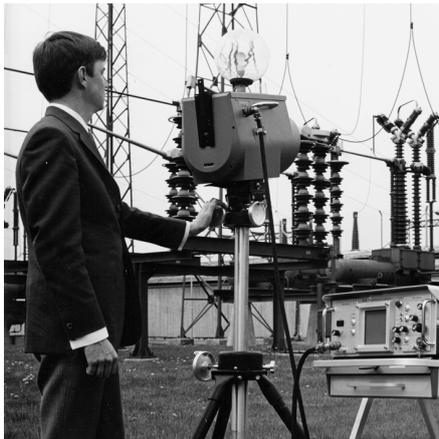
**Figura 13.2** 1969: Thermovision Modello 661. La termocamera pesava circa 25 kg, l'oscilloscopio 20 kg e lo stativo 15 kg. L'operatore inoltre doveva procurarsi un gruppo elettrogeno da 220 VCA ed un contenitore da 10 litri con azoto liquido. Alla sinistra dell'oscilloscopio è visibile l'attacco Polaroid (6 kg).
