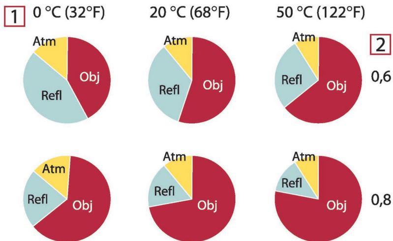
**Figura 19.3** Grandezze relative delle sorgenti di radiazione in condizioni variabili di misurazione (termocamera LW). 1: Temperatura dell'oggetto; 2: Emissanza; Obj: Radiazione dell'oggetto; Refl: Radiazione riflessa; Atm: Radiazione dell'atmosfera. Parametri fissi:  $\tau = 0,88$ ;  $T_{\text{refl}} = 20^\circ\text{C}$ ;  $T_{\text{atm}} = 20^\circ\text{C}$ .
