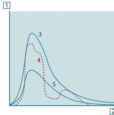
**Figura 18.8** Emissanza energetica spettrale di tre tipi di radiatori. 1: emissanza energetica spettrale; 2: lunghezza d'onda; 3: corpo nero; 4: radiatore selettivo; 5: corpo grigio.
