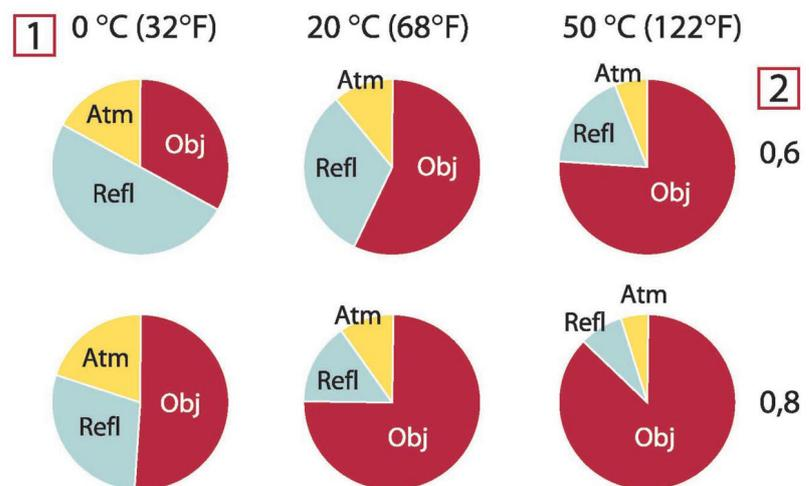
**Figura 19.2** Grandezze relative delle sorgenti di radiazione in condizioni variabili di misurazione (termocamera SW). 1: Temperatura dell'oggetto; 2: Emittanza; Obj: Radiazione dell'oggetto; Refl: Radiazione riflessa; Atm: radiazione dell'atmosfera. Parametri fissi:  $\tau = 0,88$ ;  $T_{\text{refl}} = 20^\circ\text{C}$ ;  $T_{\text{atm}} = 20^\circ\text{C}$ .
