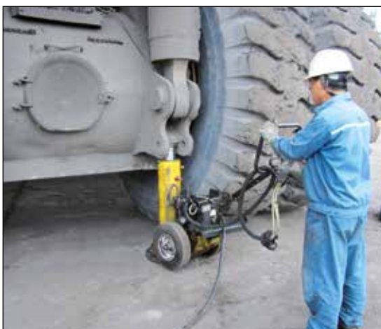
◀ Enerpac POW'R-RISER® utilisé dans l'exploitation minière pour soulever des équipements lourds.
