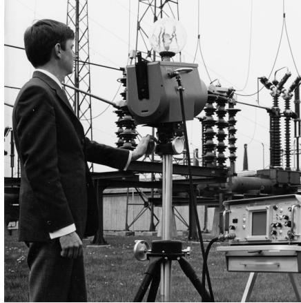
Abbildung 13.2 1969: Modell 661 der Thermovision. Die Kamera wog ca. 25 kg, das Oszilloskop 20 kg und das Stativ 15 kg. Für den Betrieb wurden darüber hinaus ein 220-Volt-Generator und ein 10-Liter-Gefäß mit flüssigem Stickstoff benötigt. Links neben dem Oszilloskop ist der Polaroid-Aufsatz (6 kg) zu erkennen.
