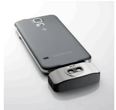
Figure 14.3 2015 : l'accessoire FLIR One pour iPhone et téléphones mobiles Android. Poids : 90 g.
