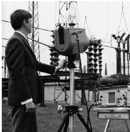
Figure 22.2 1969 : Thermovision, modèle 661. La caméra pesait environ 25 kg (55 lb.), l'oscilloscope 20 kg (44 lb.) et le trépied 15 kg (33 lb.). L'opérateur avait également besoin d'un groupe électrogène de 220 VCA et d'un récipient contenant 10 l (2,6 gallons américains) d'azote liquide. A gauche de l'oscilloscope, on distingue le Polaroid (6 kg/13 lb.).
