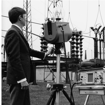
Abbildung 33.2 1969: Modell 661 der Thermovision. Die Kamera wog ca. 25 kg, das Oszilloskop 20 kg und das Stativ 15 kg. Für den Betrieb wurden darüber hinaus ein 220-Volt-Generator und ein 10-Liter-Gefäß mit flüssigem Stickstoff benötigt. Links neben dem Oszilloskop ist der Polaroid-Aufsatz (6 kg) zu erkennen.
