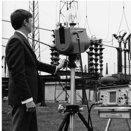
**Figure 33.2** 1969 : Thermovision, modèle 661. La caméra pesait environ 25 kg, l'oscilloscope 20 kg et le trépied 15 kg. L'opérateur avait également besoin d'un groupe électrogène de 220 V CA et d'un récipient contenant 10 l d'azote liquide. A gauche de l'oscilloscope, on distingue le Polaroid (6 kg).
