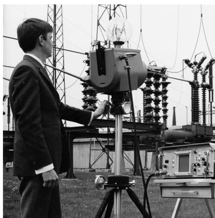
1969 : Thermovision, modèle 661. La caméra pesait environ 25 kg, l'oscilloscope 20 kg et le trépied 15 kg. L'opérateur avait également besoin d'un groupe électrogène de 220 VCA et d'un récipient de 10 L d'azote liquide. Sur la gauche de l'oscilloscope se trouve l'accessoire Polaroid (6 kg).
