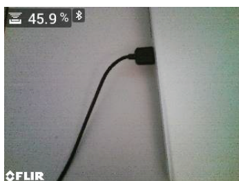
Figure 7.4 Mode Caméra numérique avec mesure d'humidité dans le coin supérieur gauche
