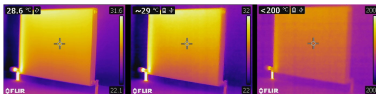
Figure 34.4 Images issues d'une caméra FLIR T440 avec des températures allant de -20 à +120\text{ °C} , (à gauche), de 0 à +650\text{ °C} (au milieu) et de +250 à +1200\text{ °C} (à droite). Tous les autres paramètres restent inchangés.
