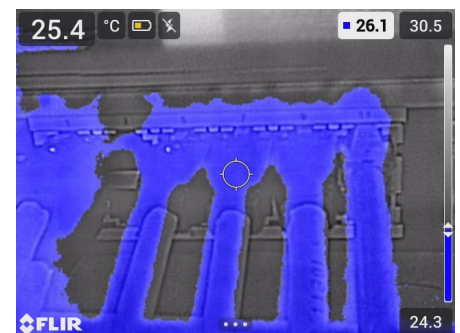
Alarm Unterhalb: Hebt alle Pixel hervor, deren Temperatur unter der angegebenen Temperatur liegt.
